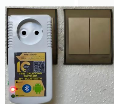
دقت داشته باشید اگر پس از چند سال استفاده از دستگاه، پس از قطعی برق تاریخ و ساعت داخلی دستگاه ریست شد باید باطری سکه ای داخل دستگاه را تعویض نمایید.
